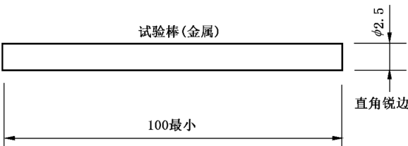
图 35 检验沟槽、孔及反向锥度用的量规
